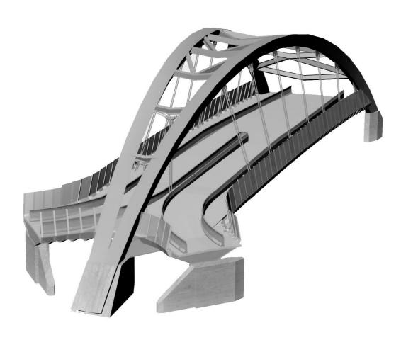
metri con un interasse di 4 metri che poggiano su traversi principali alti 2 metri con sezione a doppio T ad anima piena. Complessivamente, la struttura ha un peso di 1.700 tonnellate. Per evitare che la fase di assemblaggio interferisse con il traffico ferroviario sottostante, l'intera
